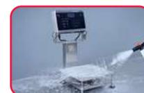
La Defender 6000 résiste aux nettoyages agressifs dans les environnements de traitement et de conditionnement avec une protection IP68 en cas d'immersion et IP69K pour les lavages au jet, une base en acier inoxydable 316 et un capteur hermétique.
