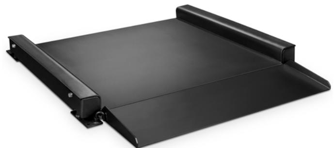
Solution surbaissée pour les applications de pesage comme les fûts, les chariots mobiles, les palettes. Pour des environnements secs ou humides suivant le modèle. Hauteur de 35 mm pour le modèle 600 kg et de 45 mm pour le modèle 1 500 kg.
